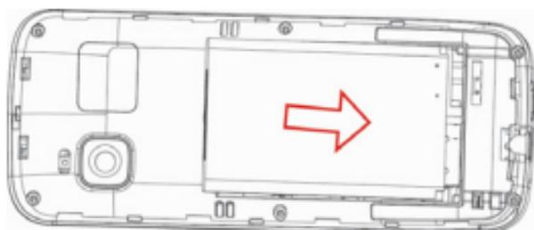
5. Vuelva a colocar la cubierta de la batería.
