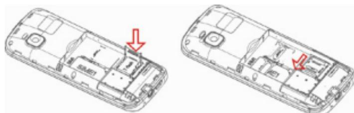
3. Inserte la tarjeta SIM deslizándola cuidadosamente en el soporte. Asegúrese de que los contactos de la tarjeta SIM estén orientados hacia el interior.
