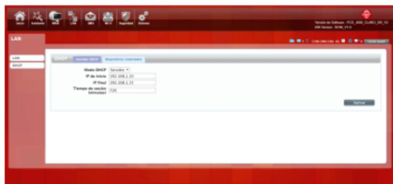
**Modo DHCP:** Seleccione servidor DHCP para activarlo; o elija Ninguno para desactivar la función
