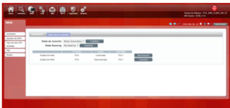
**Modo de marcado:** Seleccione el Modo automático, después de encender J600 sin operaciones adicionales, el dispositivo se conectará automáticamente a la red; al seleccionar el modo manual, deberá conectarse manualmente a la red después de abrir la página de administración WEB del J600.
