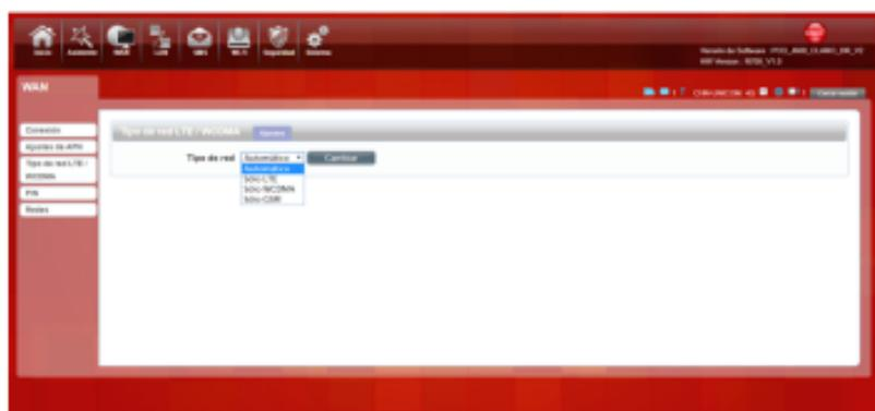
Se pueden elegir cuatro tipos de redes: Automáticamente y son 4G / 3G / 2G, LTE únicamente usa 4G, Solo WCDMA solo usa 3G, Solo GSM solo usa 2G.
