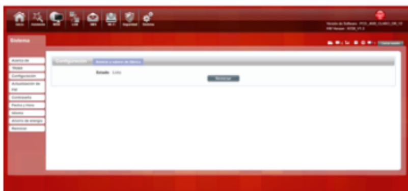
Restaurar la configuración de fábrica. Se eliminará toda la configuración personal, todas las páginas de configuración se restablecerán a los valores predeterminados de fábrica.
